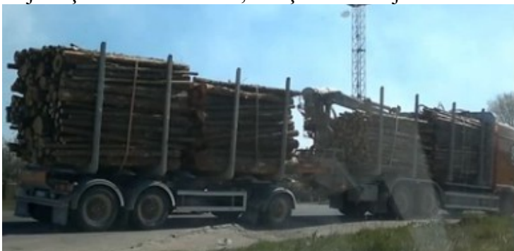
Att.2.31. Pareizs kravas novietojums piekabē [15]
